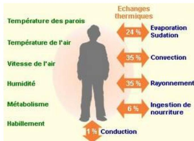
Figure II.6: Les paramètres du confort thermique.
