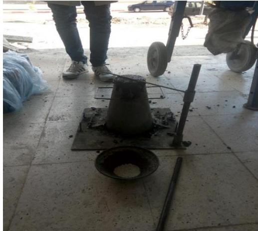
**Photo III -5:** Mesure de l'affaissement.
