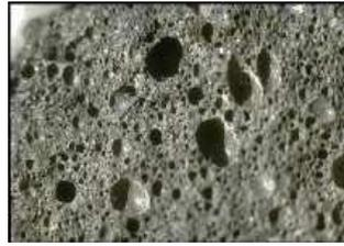
**Figure I - 8: Examen microscopique d'une pouzzolane volcanique [Delort, 2001].**
