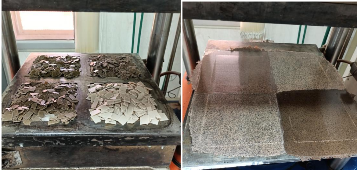
Figure III.16 : Préparation de composites par moulage par compression.
