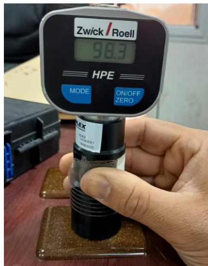
Figure III.25 : Mesure de dureté shore D avec le d'uromètre Zwick.
