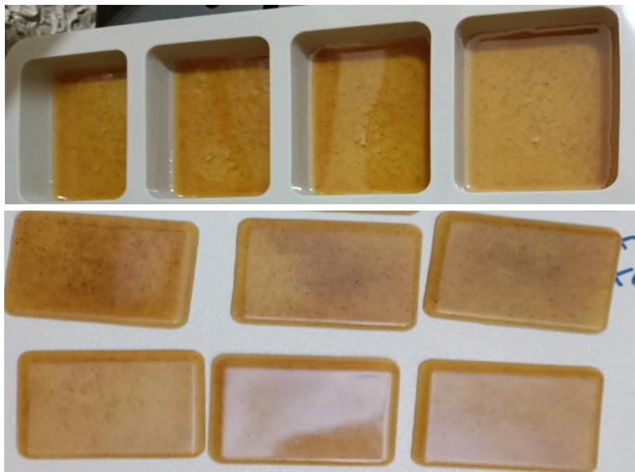
Figure III.19 : En haut la résine versée dans le moule, en bas des composites démoulés.
