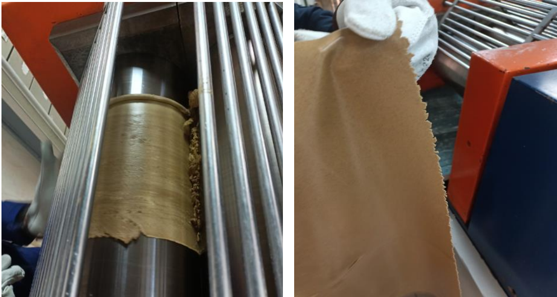
Figure III.13 : A gauche le calandrage de PVC, A droite une feuille en PVC récupérée.
