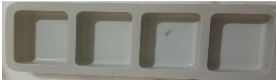
Figure III.17 : Moule en silicone utilisé dans la fabrication du composite époxy.
