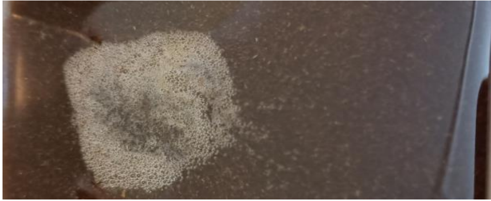
Figure III.18 : Formation de mousse et des bulles d'air sur un composite époxy/DPLF NT .
