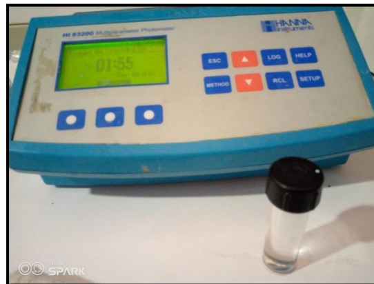
Fig.28: Appareillage utilisé pour le dosage du nitrate, nitrite, phosphate, manganèse, l'ammoniaque et le fer dans les échantillons d'eau.
