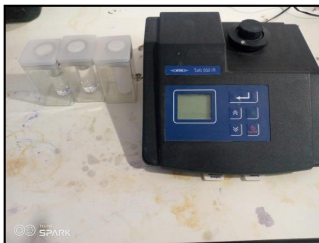
Fig.25 : Appareillage utilisé pour le dosage du la turbidité dans les échantillons d'eau.
