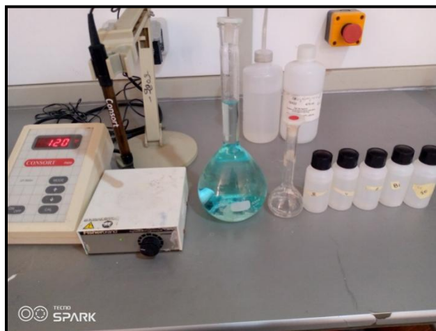
Fig.29: Appareillage utilisé pour le dosage du cuivre dans les échantillons d'eau.
