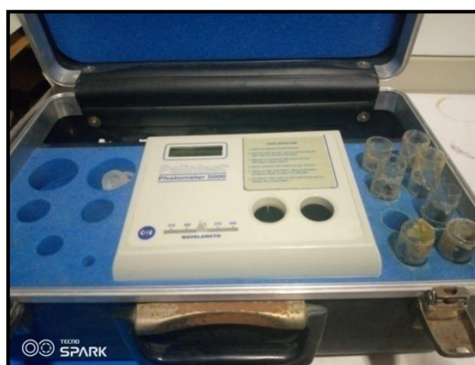
Fig.27: Appareillage utilisé pour le dosage du sulfate dans les échantillons d'eau.
