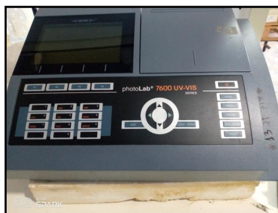
Fig.33 : Appareillage utilisé pour le dosage de la SH dans les échantillons d'eau.
