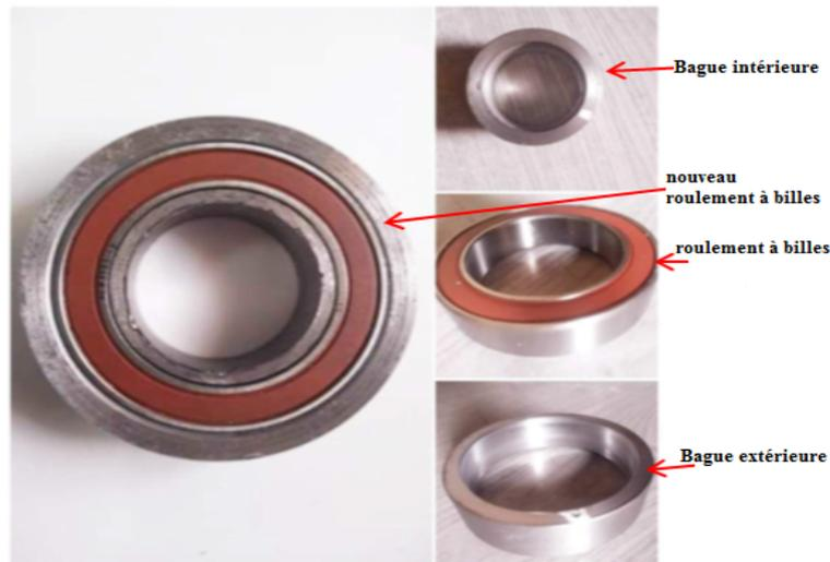
Fig 4.3: Nouveau roulement à billes avec les bagues assemblées dessus.
