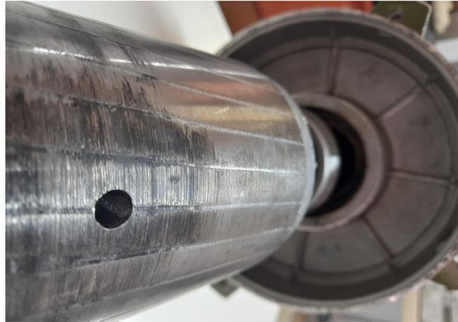
Fig 4.19: Barre de rotor cassée.
