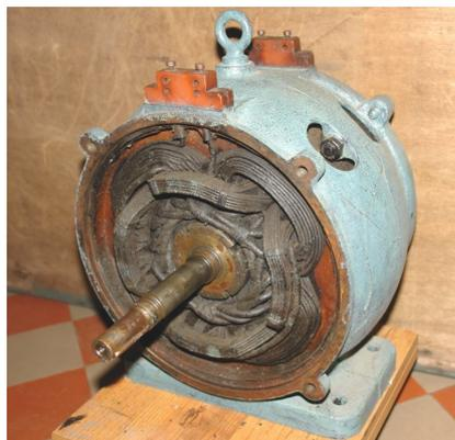
FIGURE 1.1 – Intérieur d'une machine asynchrone, R. Alioth et Cie, no 1042, vers 1891.
