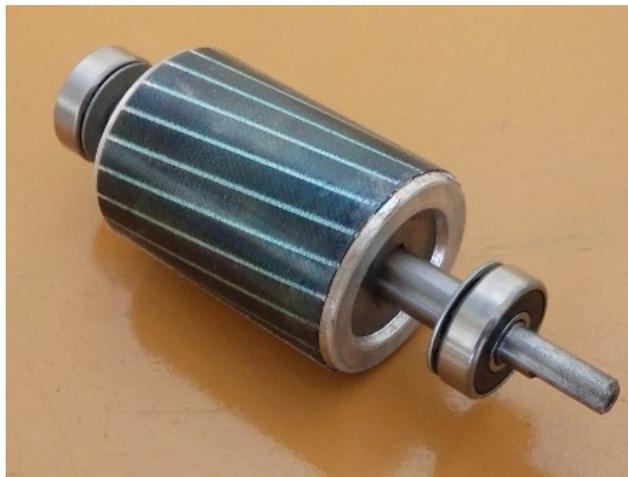
FIGURE 1.3 – Rotor à cage d'écureuil de machine asynchrone
