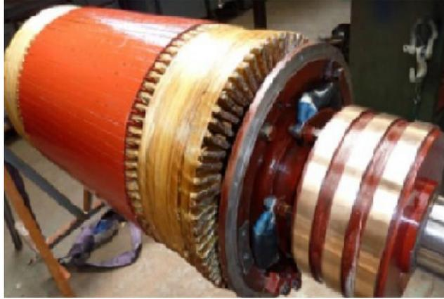
FIGURE 1.4 – Rotor bobiné à bague de machine asynchrone
