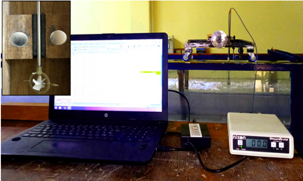
Figure 3.9 : Photo de la Micro moulinet et ses instruments annexes
