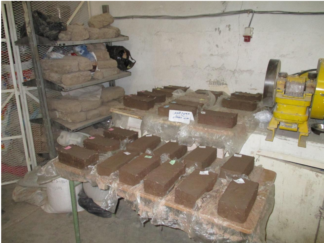
Figure A. 4 stockage et séchage de l'adobe préparé au niveau de laboratoire
