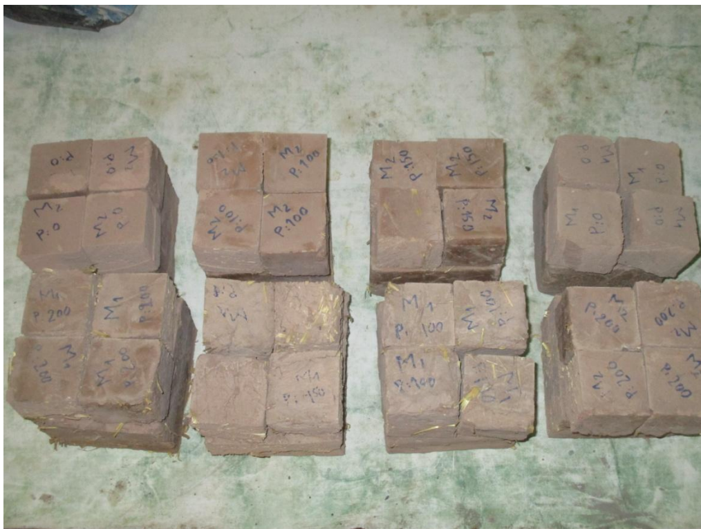
Figure A. 7 préparations des éprouvettes avant l'essai de l'écrasement
