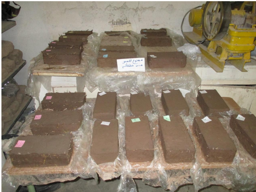
Figure A. 5 désignations de chaque adobe par un ticket coloris contient le pourcentage d'argile ajouté à chaque adobe
