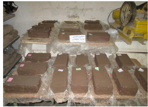
Figure IV 35 Le stockage et la cure des briques source : (auteur)
