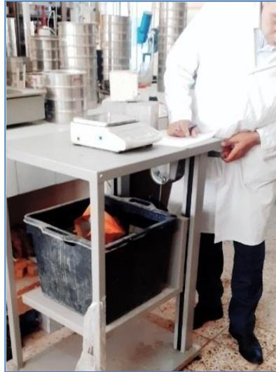
**Photo 4.6: Pesée hydrostatique pour l'essai de la porosité accessible à l'eau**
