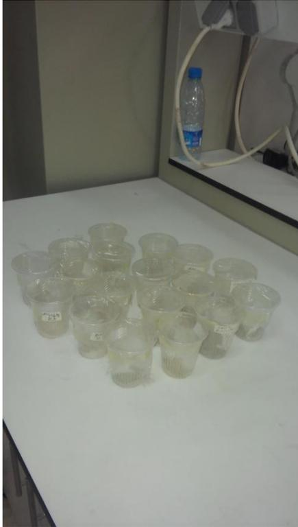
**Photo 4.13 : Echantillons en poudre pour l'analyse DRX et FTIR**
