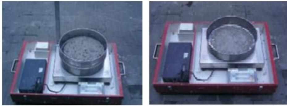
**Photo2.3 : Essai de stabilité au tamis [Ployaert et al, 2015]**
