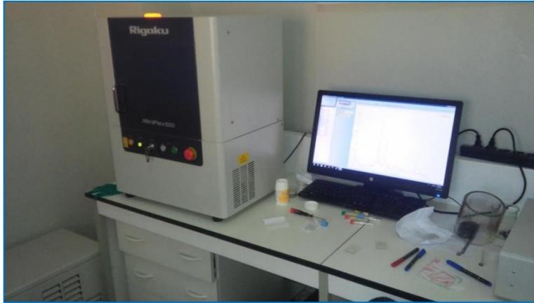
**Photo 4.10: Diffractomètre à poudre pour l'analyse par diffraction aux rayons X (Université de Biskra)**
