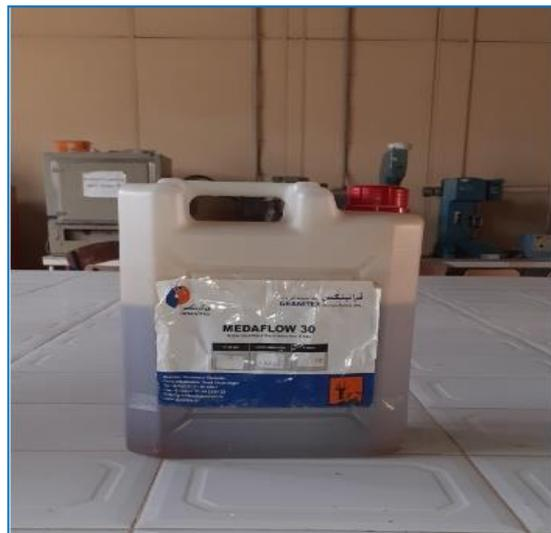
**Photo4.1: Superplastifiant de type « médaflow30 » utilisé**
