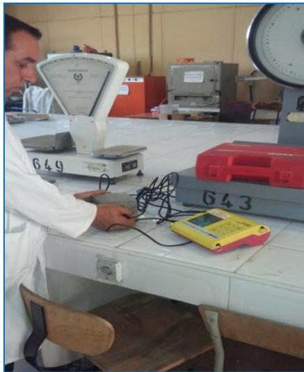
**Photo 4.5 : Essai de la vitesse de propagation d’ultrason (UPV)**
