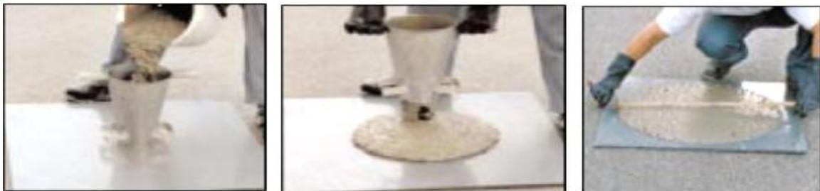
**Photo2.2 : Essai d'étalement au cône d'Abrams (Slump Flow test) [Holcim, 2004].**
