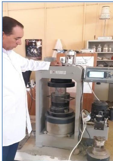
**Photo 4.2 : Essai de la résistance à la compression**
