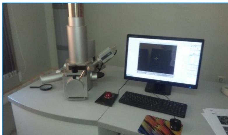
**Photo 4.12 : Microscope électronique à balayage équipé d'un spectromètre à rayons X (Université de Biskra)**
