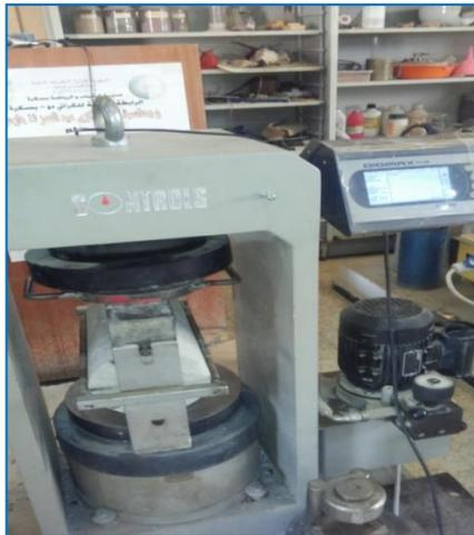
**Photo 4.3: Essai de la résistance à la traction (essai brésilien)**
