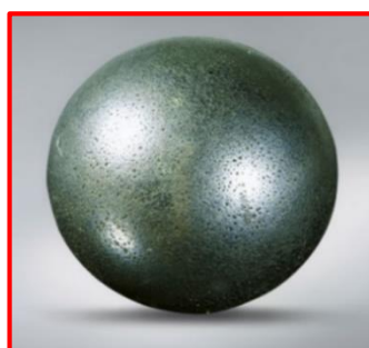
Figure I.23. Exemple de Piqûres [SKF14].
