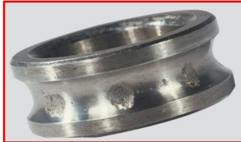
Figure I.15. Exemple d'un écaillage [SKF14].
