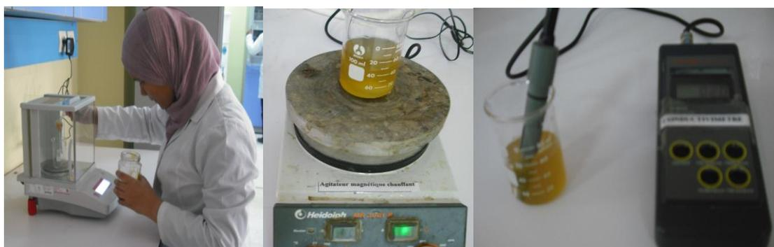
**Fig. 12** : Mesure de la conductivité électrique du miel
