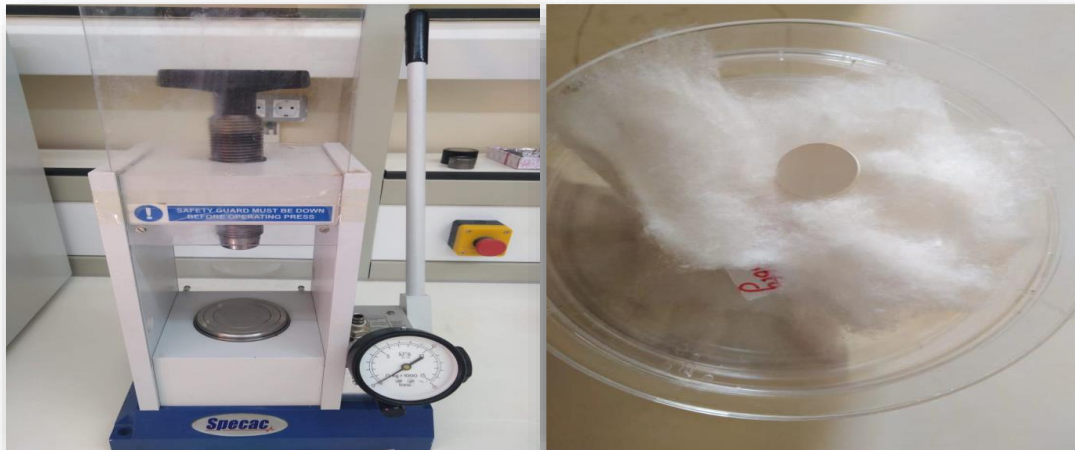
Figure II.7 : (a) : La presse utilisée pour la préparation des pastilles, (b) : Les échantillons sous forme pastilles avant le frittage.
