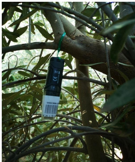
Figure 34. Enregistreur de température et d'humidité.
