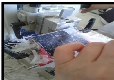
Une confection des coupes de 3 microns au microtome
