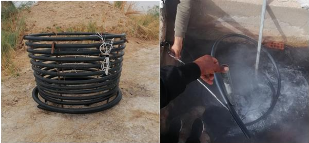
Figure.4: Echangeur immergé monotube Vertical slinky (source: l'auteur).
