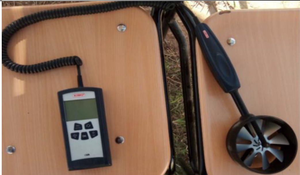
Figure.7: Anémomètre à fil chaud type Kimo VT300.
