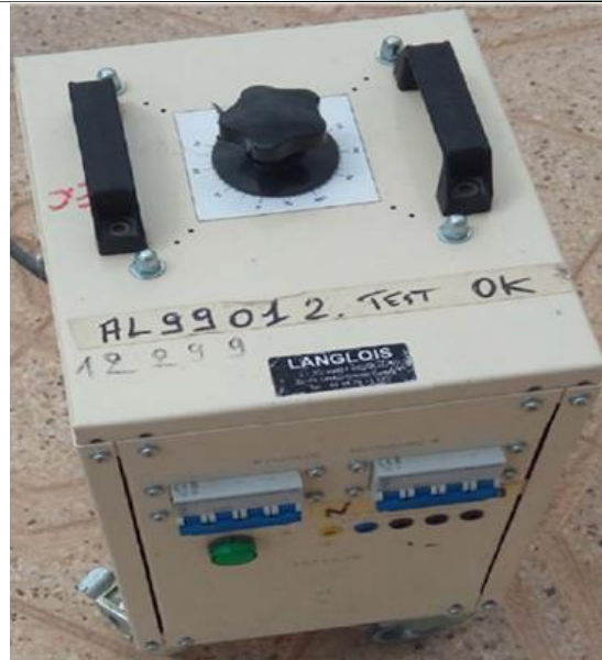
Figure.9: Autotransformateur «Langois» variable triphasé mobile (Modèle:1500 VA, \pm 1\% à \pm 3\% ).
