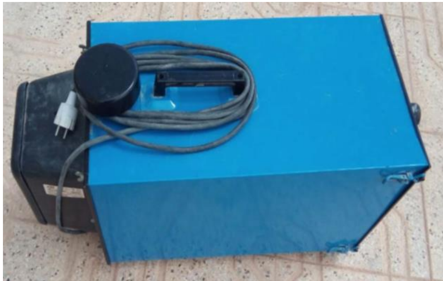
Figure.8: Aspirateur pour le pompage d'air (Type MPF.803, 1000W).
