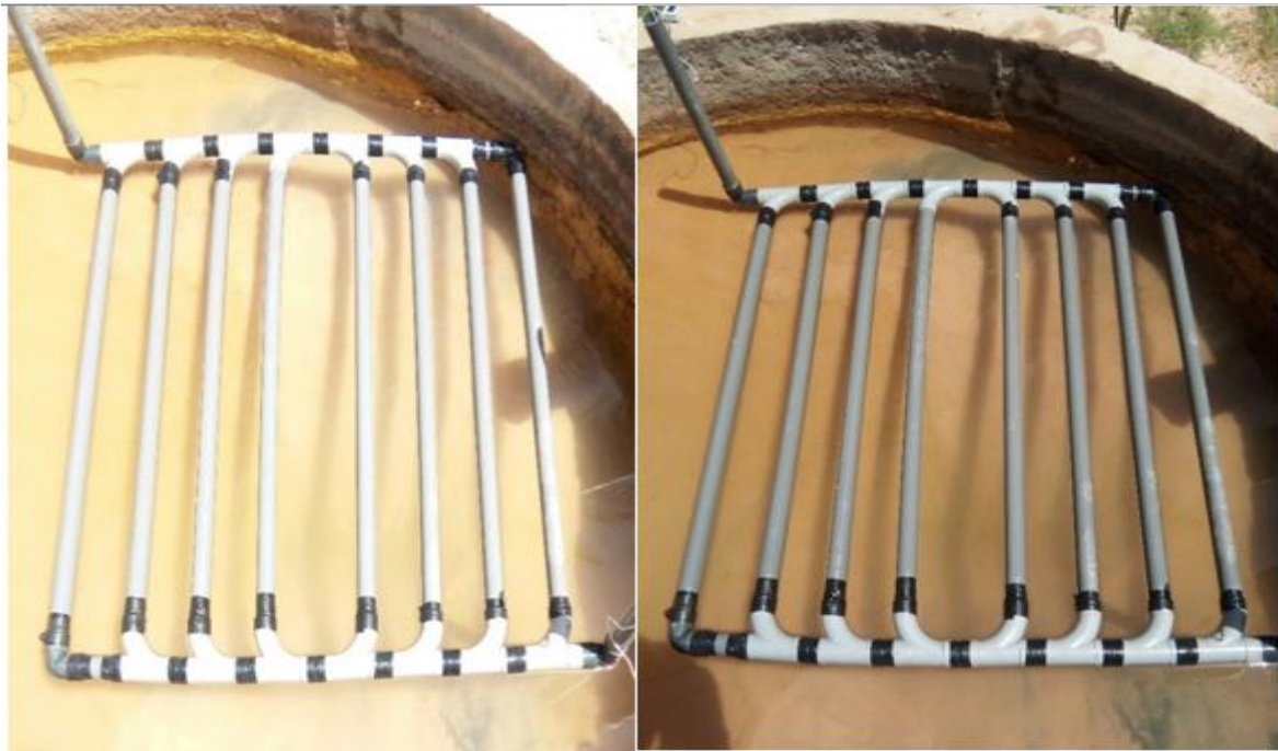
Figure.23: Echangeur de chaleur à faisceau tubulaire immergé de 8 tubes.
