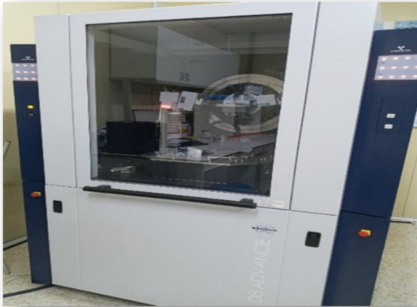
Figure I.6 : Appareil de diffraction des rayons X (DRX) utilisé, CRAPC-Biskra.
