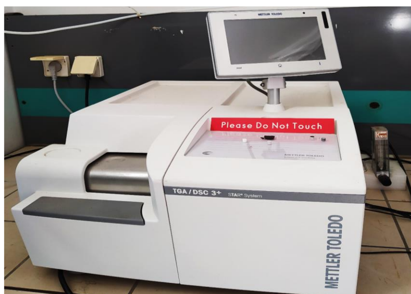
Figure I. 5 : Appareil Mettler Toledo TGA/DSC 3+ utilisé
