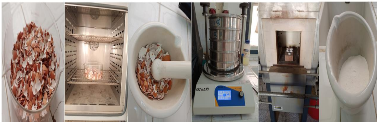
Figure II .1 : Etapes de préparation d' oxyde de calcium CaO à partir de coquilles d'œufs
