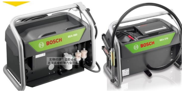
Figure II.5 : Appareils Bosch BEA 060 et BEA070 ont été utilisés pour mesurer les émissions d'échappement et la densité de fumée
