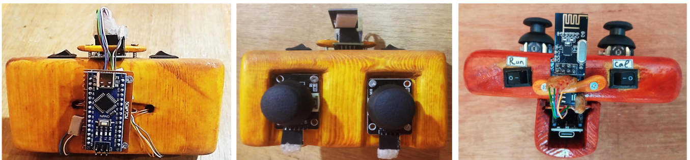
Figure V. 5 Émetteur conçu pour le contrôle manuel du quadrirotor
