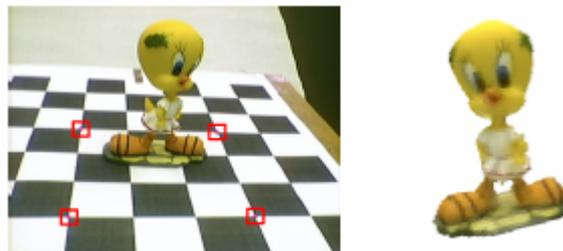
**Figure B.5 :** Une image d'entrée choisie avec quatre points de référence qui doivent être choisis manuellement par l'utilisateur, et la reconstruction de l'objet en utilisant la coloration de voxel.
