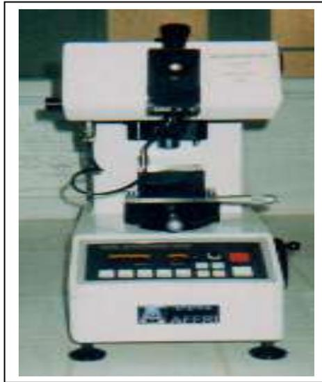
Figure II.8 : microduremètre de type AFFRI.
