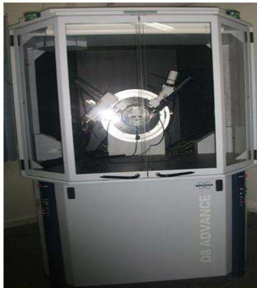
**Figure II.4:** Diffractomètre des rayons X de type Bruker D8 Advance
