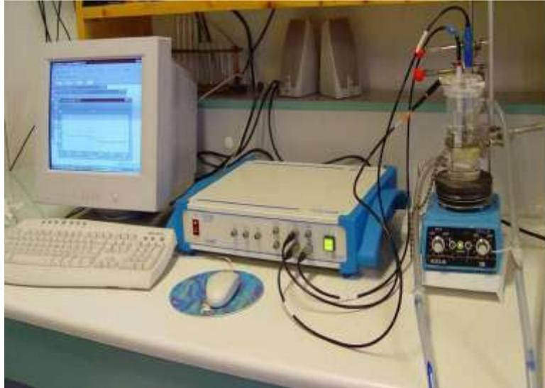
**Figure II.10:** Montage de la cellule du test de polarisation.
