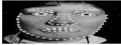
Figure 2.4 Modèle Actif d'Apparence.
