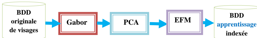
Figure 5.28 Schéma de la phase enrôlement de notre modèle RV.
