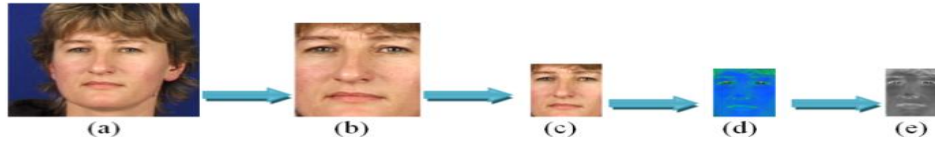
Figure 5.5 (a) Image originale, (b) Image découpée, (c) Image décimée, (d) Image en système HSV, (e) La composante S de HSV.
